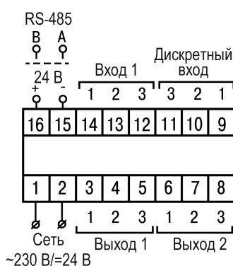
Рисунок 5.5 – Общая схема подключения TRM10–Щ5
